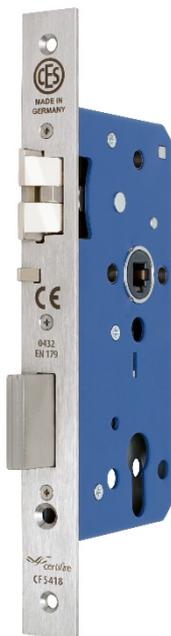
Fig. 2: serratura antincendio con funzione antipanico E (leva comando scrocco) e scrocco di bloccaggio, certificata in conformità con le norme DIN EN 12209 ed EN 179
