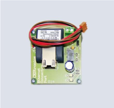
Bei bereits bestehenden CEMO-Installationen können die vorhandenen CEMO-Steuerungen, zu einer online-fähigen CEMO-NET-Version einfach nachgerüstet werden.
